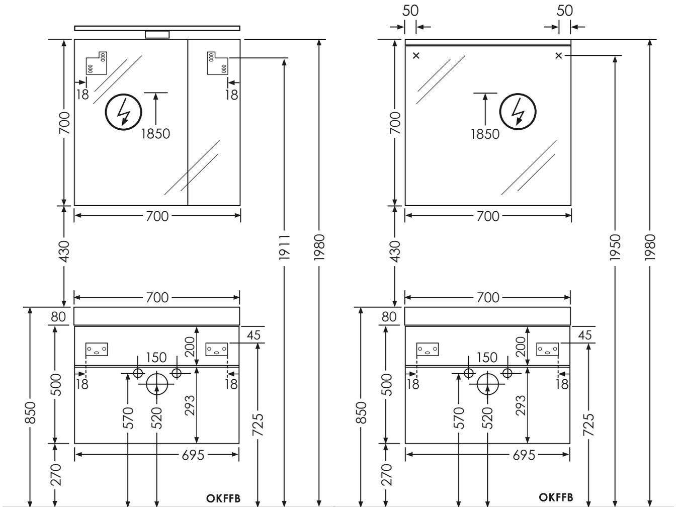
OKFFB = Oberkante Fertigfußboden | Alle Maßangaben in Millimeter | Höhenangaben sind empfohlen und müssen nicht eingehalten werden!
