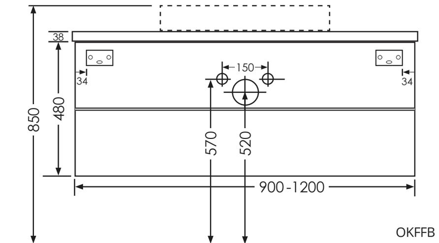
OKFFB = Oberkante Fertigfußboden | Alle Maßangaben in Millimeter | Höhenangaben sind empfohlen und müssen nicht eingehalten werden!
