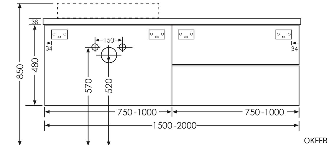
OKFFB = Oberkante Fertigfußboden | Alle Maßangaben in Millimeter | Höhenangaben sind empfohlen und müssen nicht eingehalten werden!
