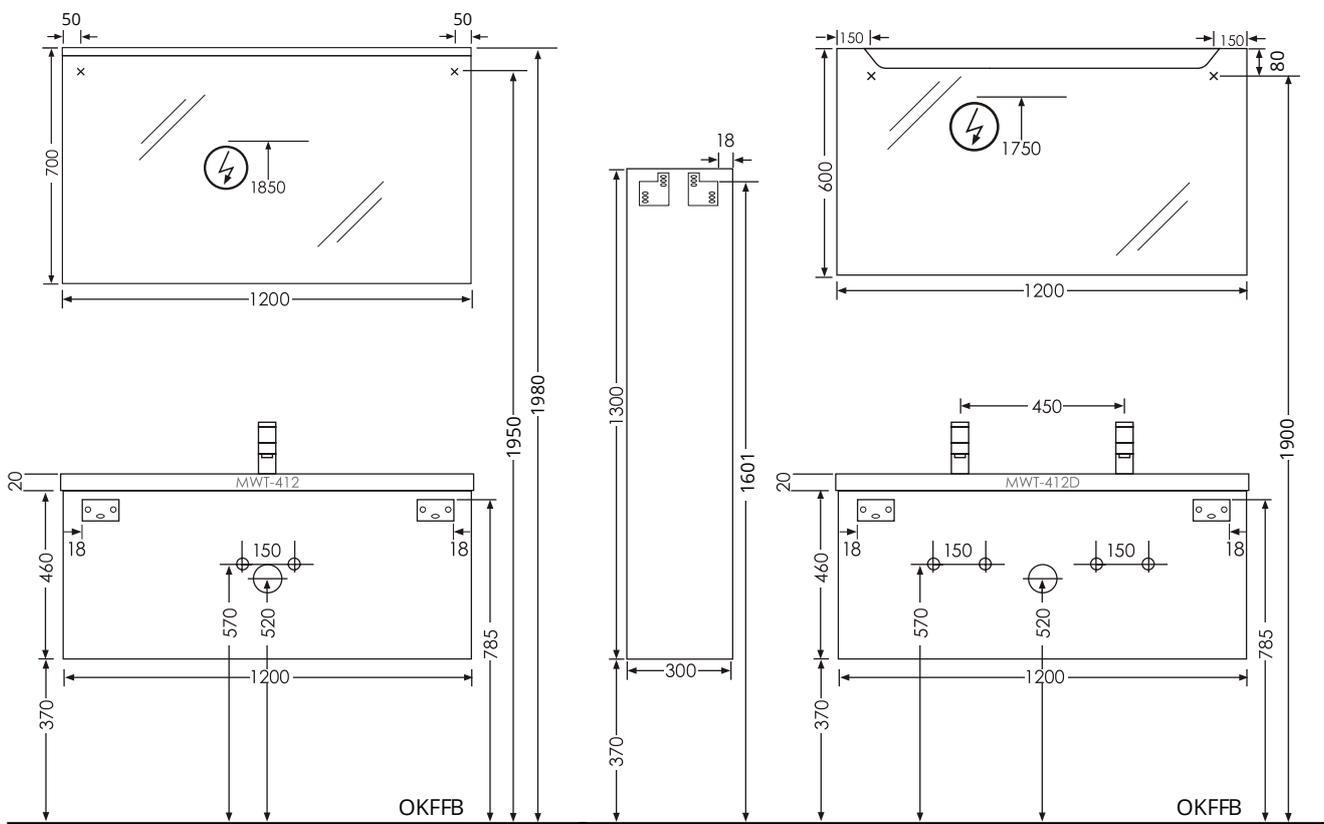
OKFFB = Oberkante Fertigfußboden | Alle Maßangaben in Millimeter | Höhenangaben sind empfohlen und müssen nicht eingehalten werden!
