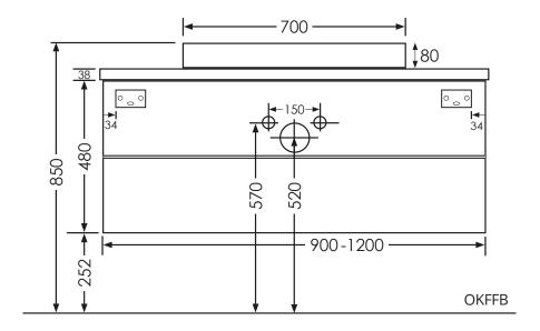
OKFFB = Oberkante Fertigfußboden | Alle Maßangaben in Millimeter | Höhenangaben sind empfohlen und müssen nicht eingehalten werden!
