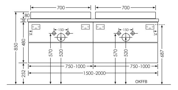
OKFFB = Oberkante Fertigfußboden | Alle Maßangaben in Millimeter | Höhenangaben sind empfohlen und müssen nicht eingehalten werden!
