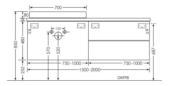
${\sf OKFFB = Oberkante \; Fertigfußboden \; \mid \; Alle \; Ma\$angaben \; in \; Millimeter \; \mid \; H\"{o}henangaben \; sind \; empfohlen \; und \; m\"{u}ssen \; nicht \; eingehalten \; werden!}$
