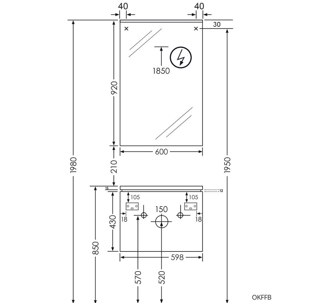
OKFFB = Oberkante Fertigfußboden | Alle Maßangaben in Millimeter | Höhenangaben sind empfohlen und müssen nicht eingehalten werden!
