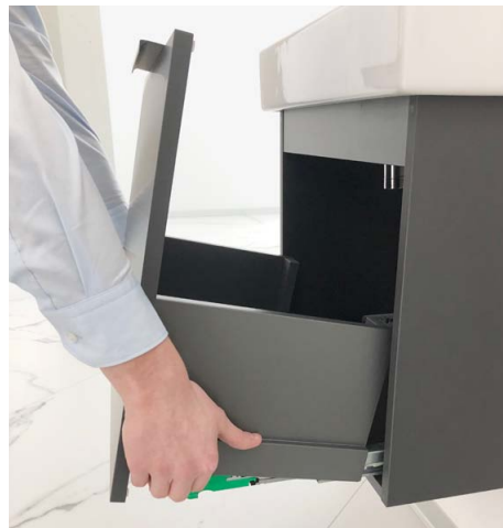
Auszug an beiden Seiten festhalten, diesen mit Schwung nach oben anheben (der Auszug ist nur eingeklickt, Sie lösen damit den Klickmechanismus). Auszug herausnehmen (siehe Video auf unserer Online-Seite „Montagevideos“).
