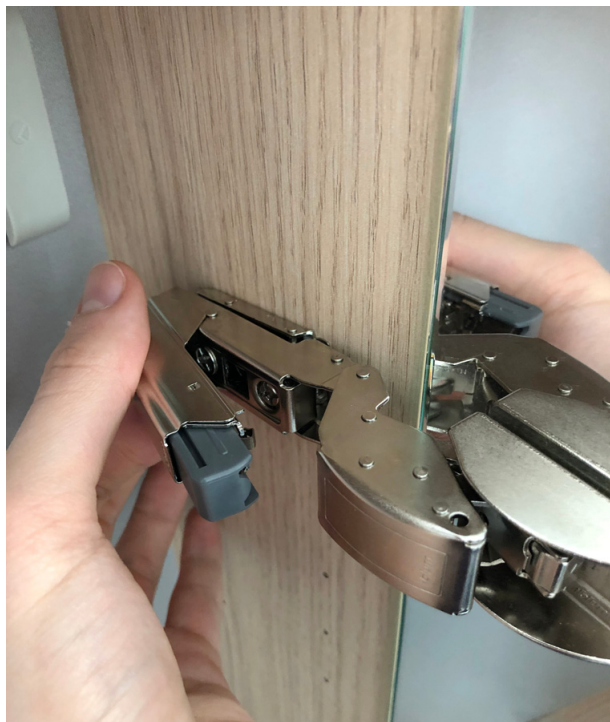
Abb. 4 | Montage von Glastürdämpfung und Abdeckkappe
