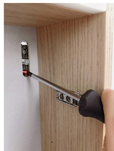
Fixierung an der Montageplatte
