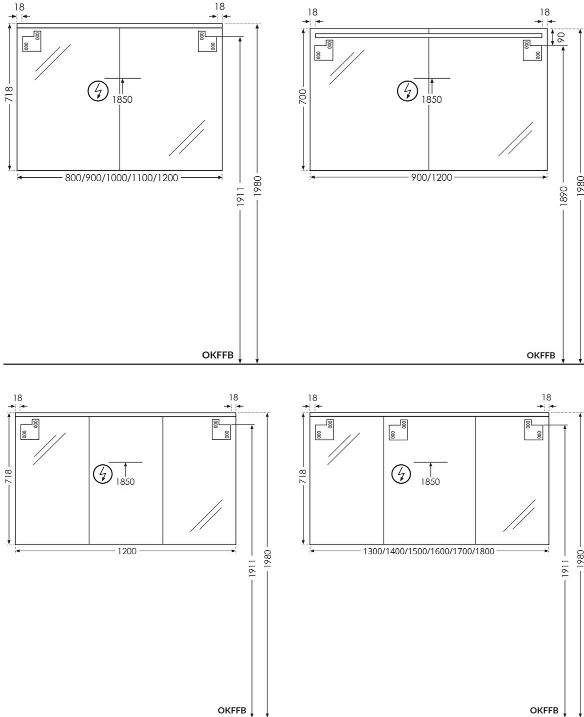
OKFFB = Oberkante Fertigfußboden | Alle Maßangaben in Millimeter | Höhenangaben sind empfohlen und müssen nicht eingehalten werden!
