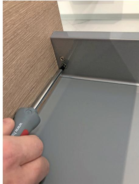
**3b.** Höhe mit der unteren Schraube ausrichten.
