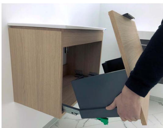
Korpusschienen ausziehen und den Auszug aufsetzen.
